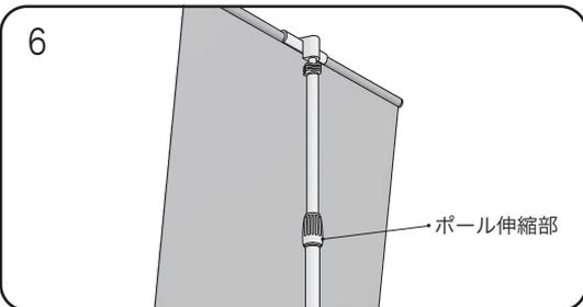
伸縮部をゆるめて引き伸ばし バナーが張った状態で締めて固定します
