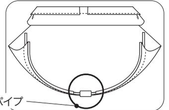
2. 中央の切り欠け部で補助パイプを通しながら 袋全体に通します
