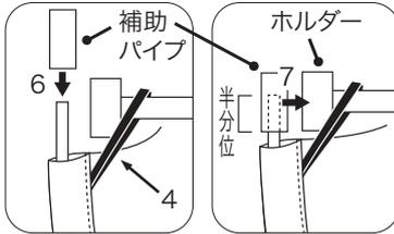
6. 補助パイプを湾曲した部材の端にパイプの長さの半分程度通して
